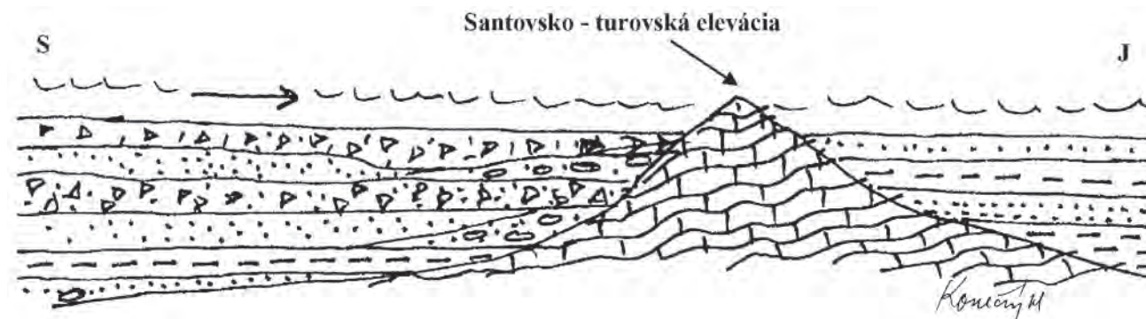
Obr. 1. Schéma znázorňuje transport vulkanoklastického materiálu Štiavnického stratovulkánu a jeho uloženie v sedimentačnom bazéne v sublitorálnej zóne. V južnej časti sedimentačného bazénu vystupuje elevácia predvulkanického pobrežia (© V. Konečný).
