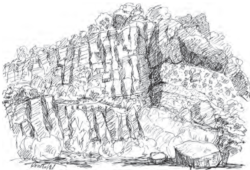
Obr. 1. Opustený andezitový lom východne od obce Kozárovce. V ľavej spodnej časti je spodný lávový prúd so subvertikálnou hrubostĺpcovou odlučnosťou a v jeho nadloží vrchný lávový prúd, podobne so stĺpcovou odlučnosťou. V pravej časti sú v nižšej úrovni odkryté zvrstvené epiklastické pieskovce a v ich nadloží redeponované hyaloklastitové brekcie. Vyššie, v nadloží hyaloklastitovej brekcie je uložený vrchný lávový prúd, ktorý prechádza do pásma brekciácie a hyaloklastitovej brekcie (© V. Konečný).
