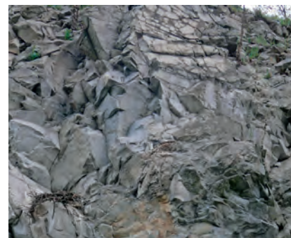
Foto 2. V stenách lomu je andezit s blokovo odlučnosťou prevažne podľa subvertikálnych plôch (© P. Pachinger).
